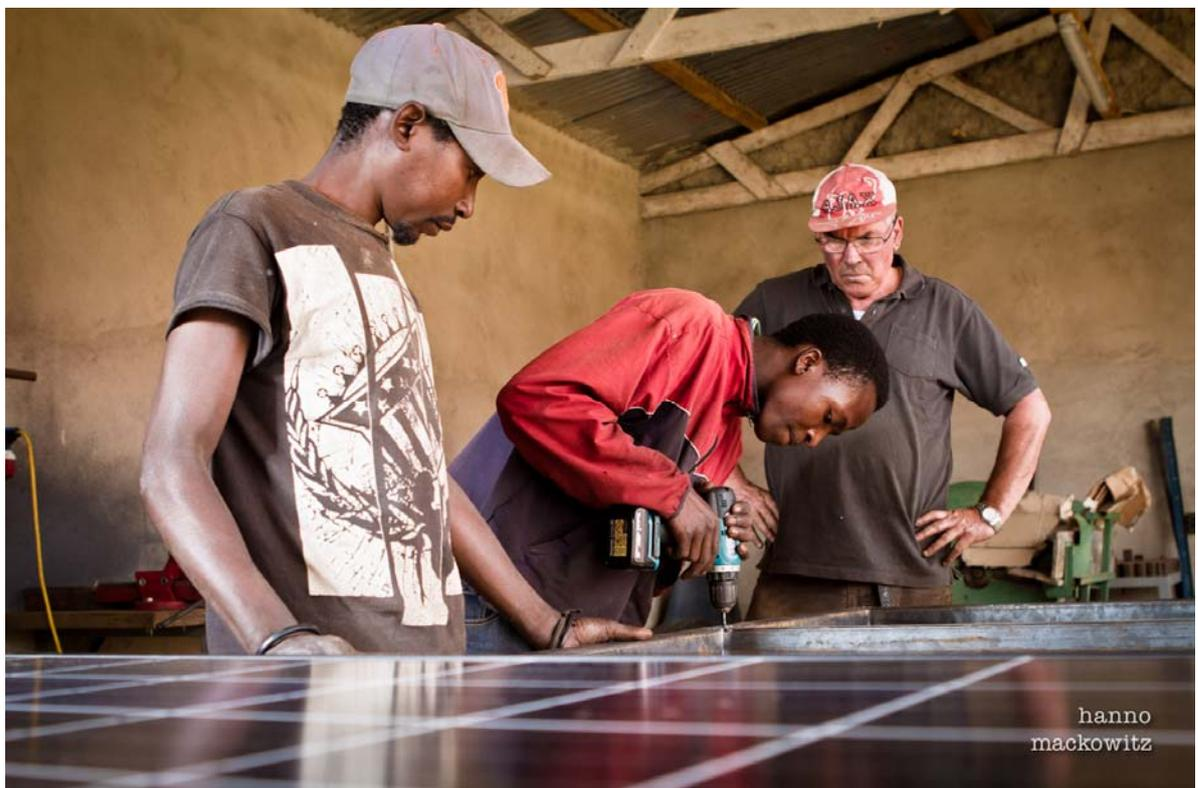
In der Schlosserwerkstätte der VTC-Zentrale Mdabulo wird der Stahlrahmen für die Befestigung gefertigt
