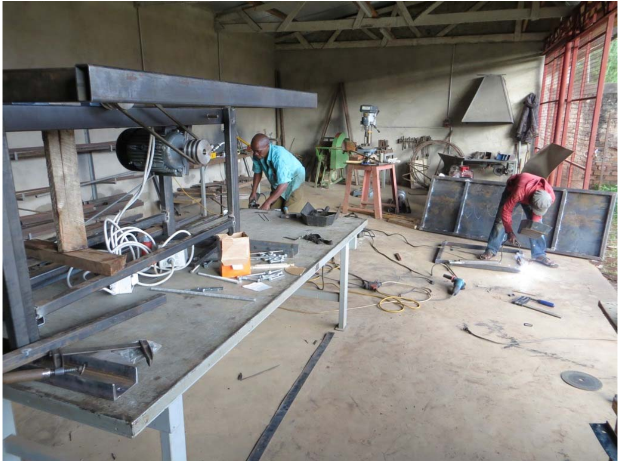
„Prototypen“ für künftige Produkte aus den Metallwerkstätten Mdabulo (links im Vordergrund – eine angefangene Tischkreissäge, rechts im Bild –Stahltüren für Power House u.a.m.)
