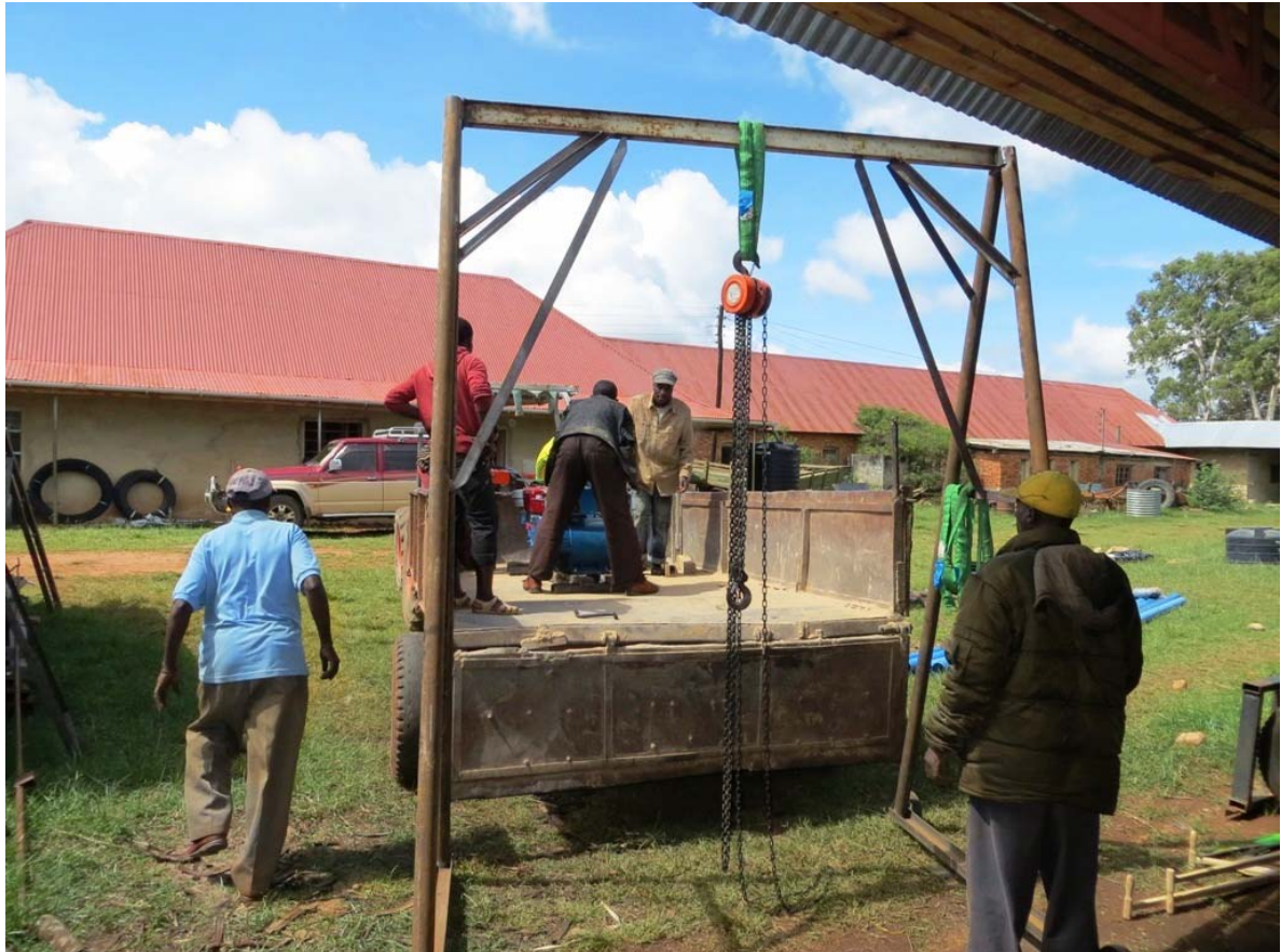
Für die Verladung des Generators baute Hannes Rauch eine eigene Hebevorrichtung
