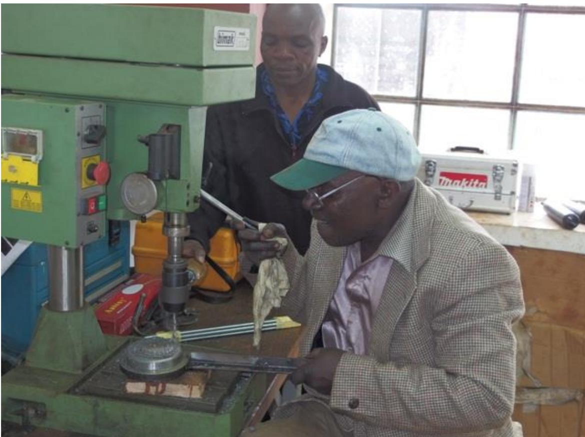
Abb. Einheimischer Fachmann bei Bohrungsarbeiten für den Prototyp-Widder in der RDO - Metallwerkstätte
